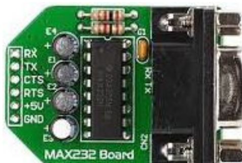
Figur 14 UART <-> RS-232 konverter kreds fra Maxim, monteret på printboard.
